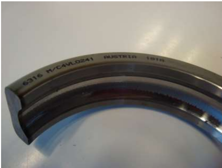
Fig. 11 Lagret ovan är ett Insocoat-lager från SKF som har havererat p.g.a. lagerströmmar. "Blixtläsmönstret" indikerar tydligt att det är lagerströmmar som orsakat haveriet.
